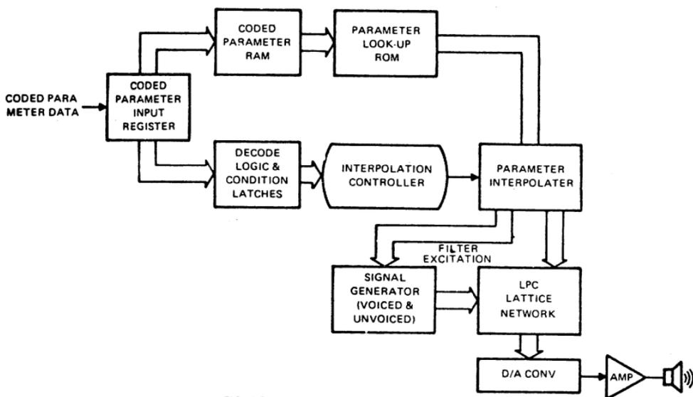
FIGURE 4 – SYNTHESIZER BLOCK DIAGRAM
