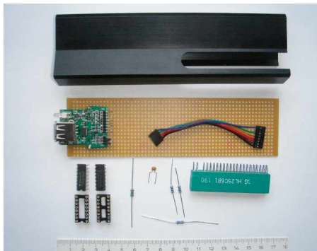
Externe TTL-USB Sparversion vor dem Zusammenbau (K.-D. Jahnke)
