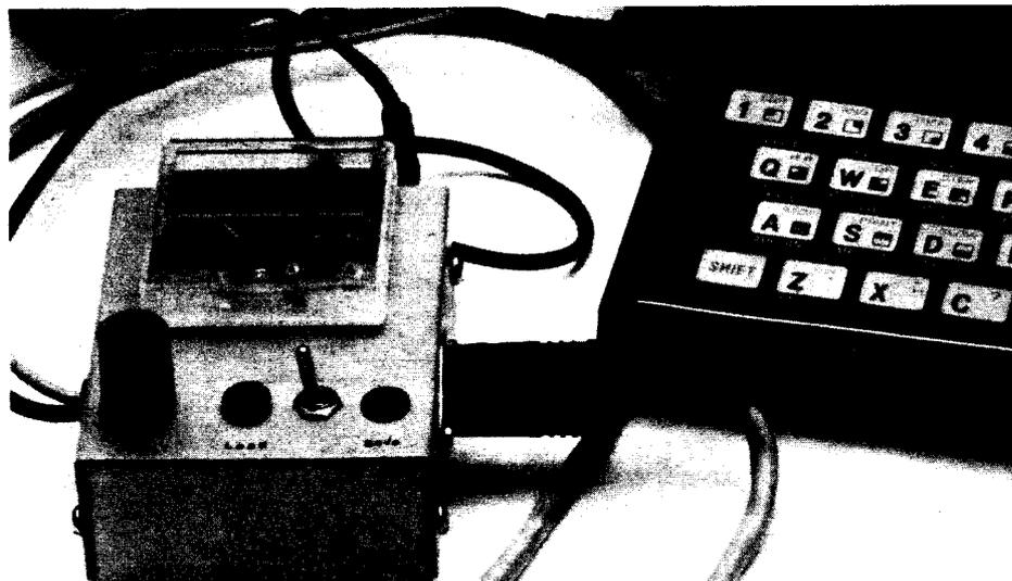
① LOAD-/SAVE-Interface: Zwischen Kassettenrecorder (mit DIN-Buchse) und Computer eingeschleift, raubt das Interface dem ZX 81 seine „Ladehemmungen“ Foto: Neumayr
