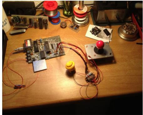
Der Testaufbau – ZX81-Bastelplatine mit Joystick und Feuerknopf
