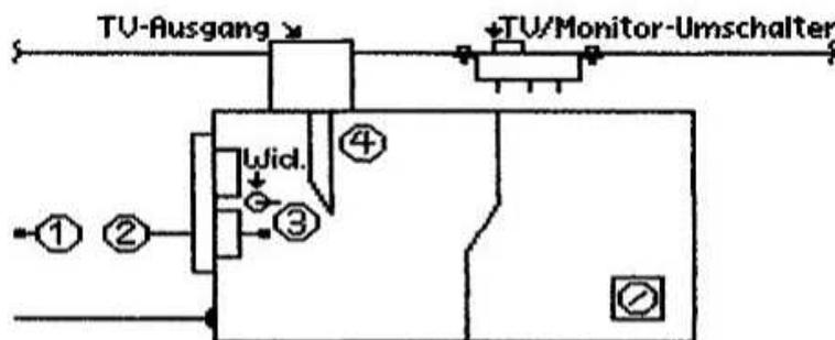
In den Modulator führen zwei Leitungen, obwohl drei Öffnungen vorhanden sind: Die erste, die direkt am Metall des Gehäuses angebracht ist, und die zweite (für uns wichtig!), die durch eine Plastik-Manschette in den Modulator führt (die unbenutzte Öffnung der Manschette kann nachher für zwei der Drähte des Schalters verwendet werden, dadurch kann man nämlich die Abdeckplatte wieder anbringen und den HF-Teil wieder abschirmen!).
