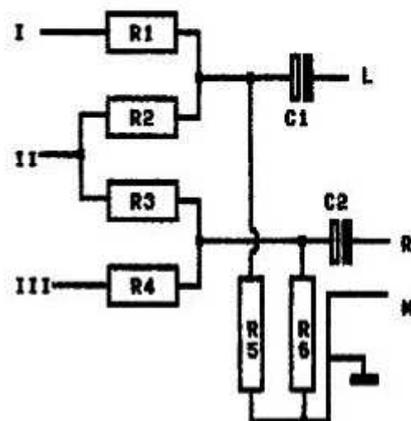
Der Ausgang wird an eine Stereo-Klinkenbuchse angeschlossen, wobei L (links) und R (rechts) sowie Masse (M) anzuschliessen sind.
